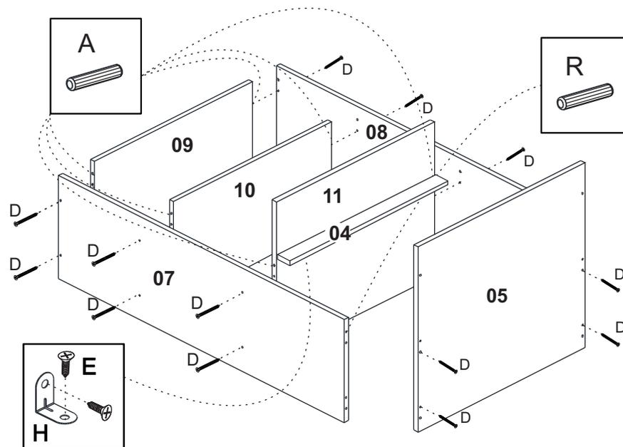
03 - Encaixar a parte superior com a parte inferior utilizando cavilhas **A** e cantoneiras **H**. Fixar os fundos com pregos **B** e unir os fundos do balcão com perfil **H**.
