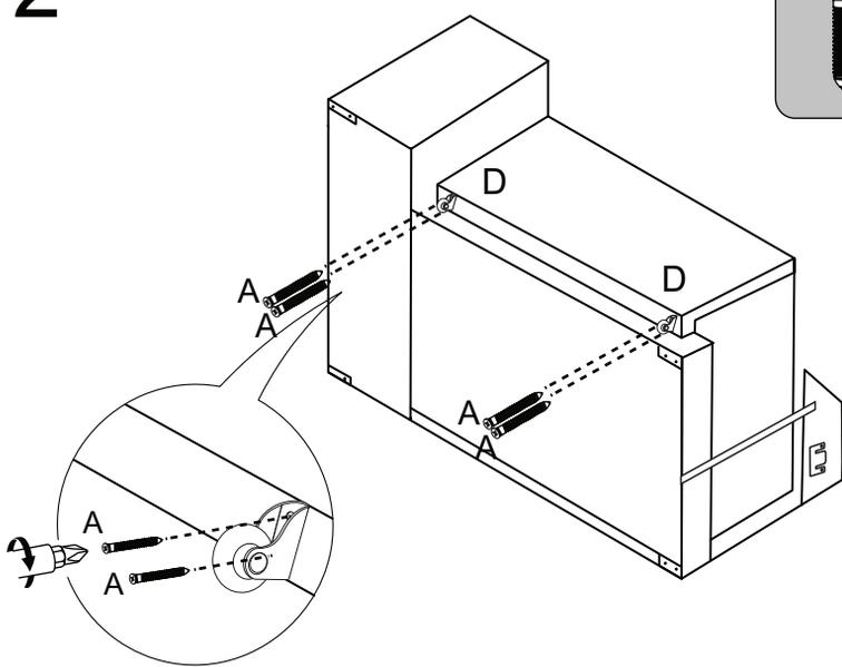
**3** Os módulos possuem engates para uní-los. Encaixe esses engates metálicos de cima para baixo.
