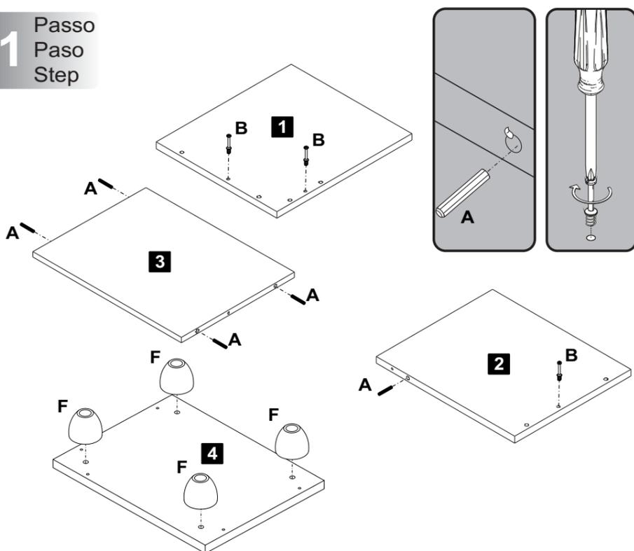
**A** Cavilha 05 **B** Minifix Ø7x30mm 03 **F** Sapata Aros com pino 04
