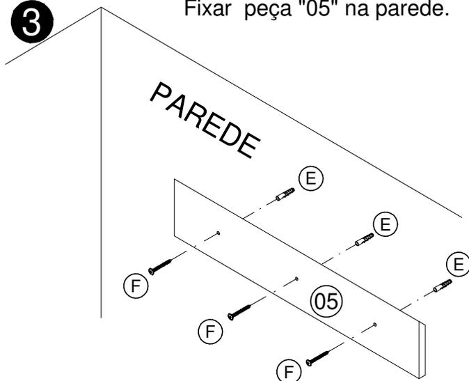
Atenção: Utilizar nível para fixação..
