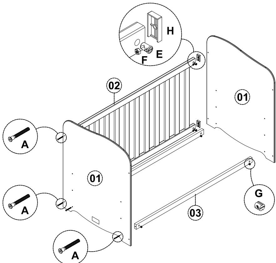
7º - Fixe os barrotes 1300 nas cabeceiras, inicialmente, **na posição mais baixa**, utilizando parafuso CAB11 SXINT 1/4"x50 s/ pont. e porca cilíndrica.
