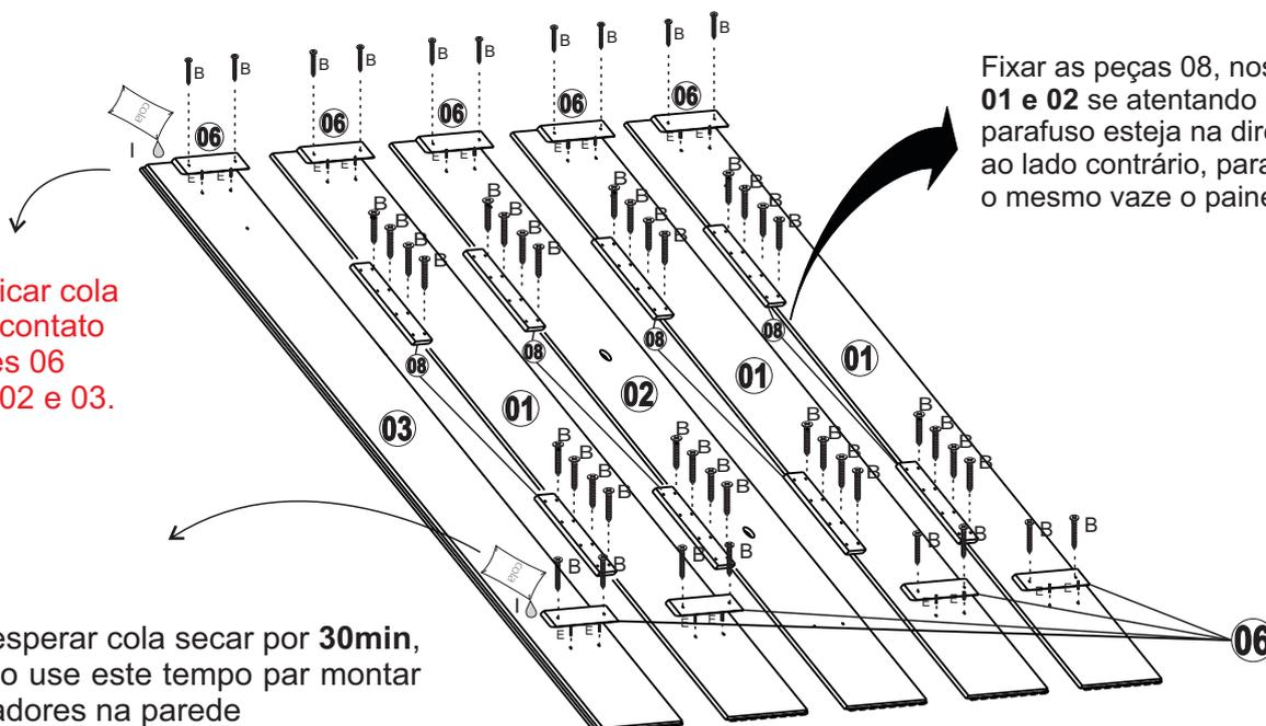
**Atenção:** Aplicar cola nas faces de contato entre fixadores 06 e painéis 01, 02 e 03.
