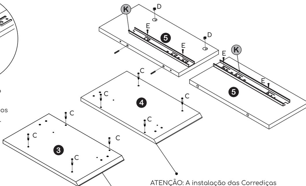
ATENÇÃO: A instalação das Corrediças nas Laterais (3) e (4) deverá ser feita, após a instalação dos Pés!
