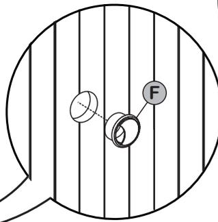
**Atenção!** Caso seja necessário, com auxílio de uma broca copo, determinar onde será fixado o conjunto passa-fio (F).
