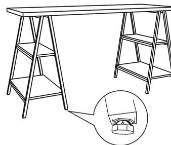
2.1: Parafuse as sapatas C nas buchas e nivele conforme necessário.
