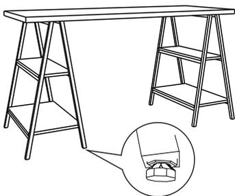
2.1: Parafuse as sapatas C nas buchas e nivele conforme necessário.
