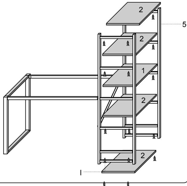
**4º PASSO:** PARAFUSAR O TAMPO NA ARMAÇÃO JÁ MONTADA CONFORME O DESENHO E COLOCAR AS TAMPINHAS DE ACABAMENTO.
