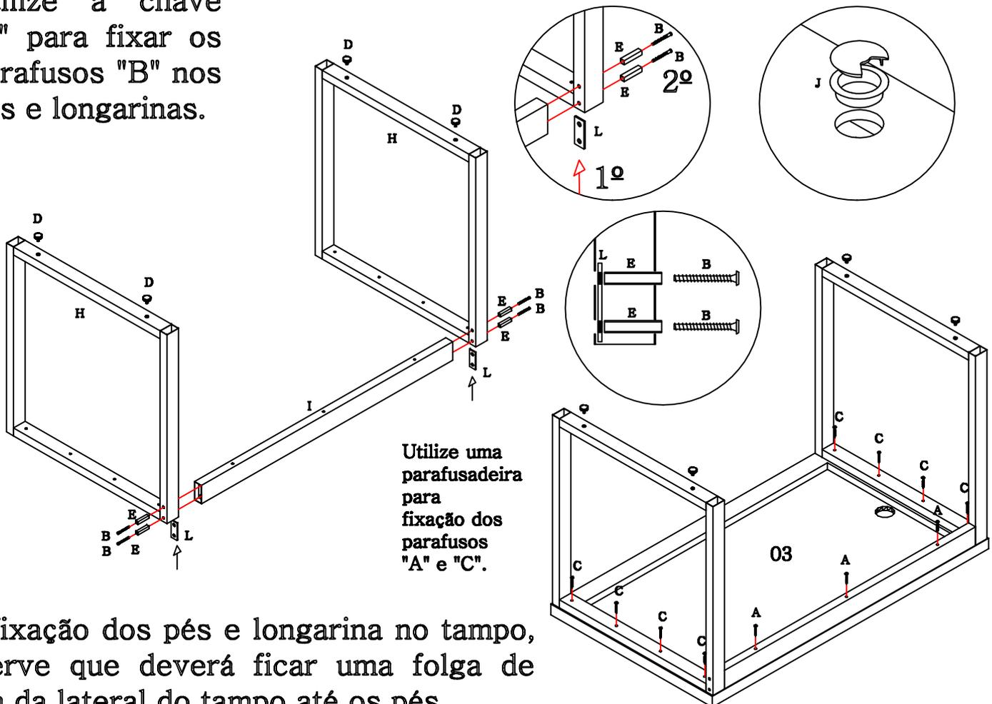
Utilize uma parafusadeira para fixação dos parafusos "A" e "C".
