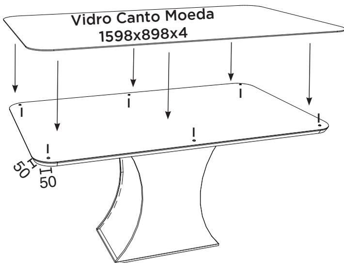
A pintura do Vidro deve ficar virada para baixo, depois ajustá-lo sobre os batentes de silicone (I).
