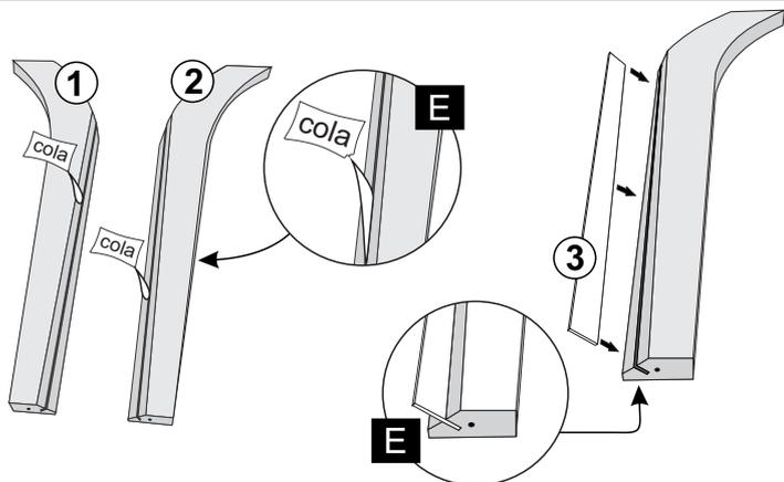
**2º - JUNTE AS PEÇAS N.º2 NAS PEÇAS N.º3 E FIXE AS PEÇAS N.º1 E N.º2, UTILIZANDO SAPATA+PREGOS, UNINDO AS DUAS PARTES.**
