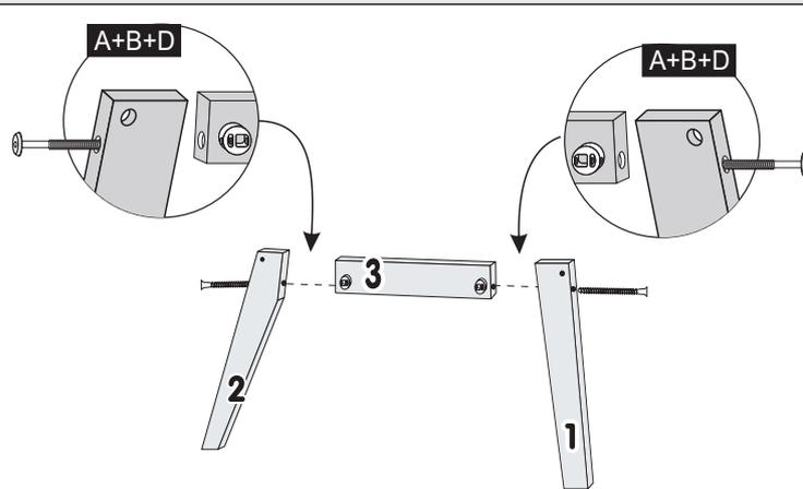
**2º - UNIR O CONJUNTO LATERAL COM AS PEÇAS N.º3, UTILIZANDO ANEL FIXADOR+PARAF. 1/4X70 CAB. 13mm. COM CHAVE ALLEN 4mm.**
