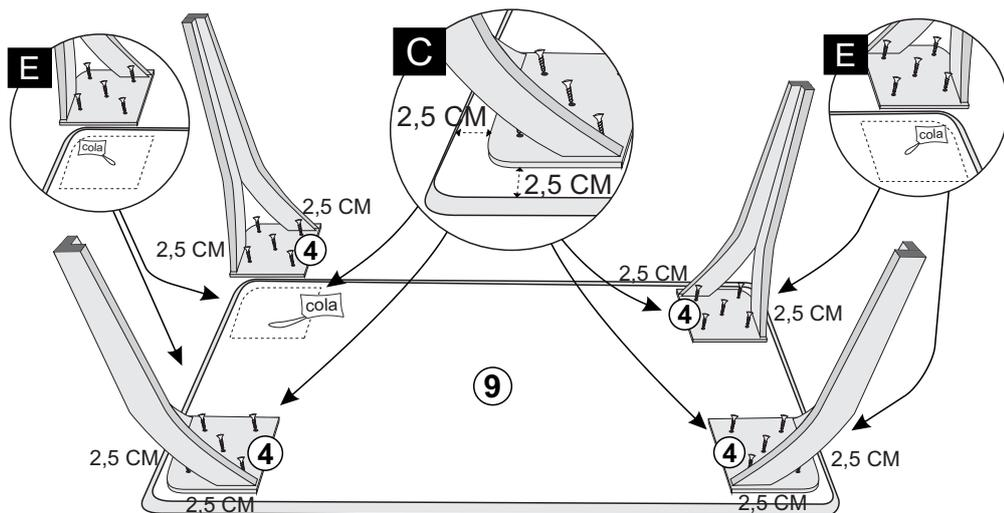
**5º - POSICIONE AS PEÇAS N.º5 E N.º6 NAS PEÇAS N.º1 E N.º2 COMO ESTÁ ABAIXO, E FIXE COM PARAF. 4,0X30 FLANG. EM SEGUIDA, COLOQUE CANTONEIRA 4 FUROS FIXANDO AS PEÇAS N.º5 E N.º6 NA PEÇA N.º9, UTILIZANDO PARAF. 3,5X14.**
