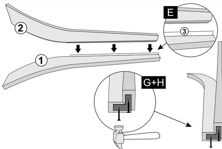
**3º - FIXE A PEÇA N.º4 NAS PEÇAS N.º1 E N.º2 UTILIZANDO PARAF. 07X50 CAB.10mm. PHILLIPS. OBS: LADO ESCARIADO PARA FORA.**
