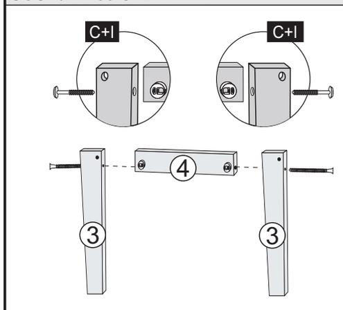
**4º - UNIR O CONJUNTO LATERAL COM A TRAVA FRONTAL E TRASEIRA Nº4 UTILIZANDO ANEL FIXADOR + PARAFUSOS 1/4X70 CAB.13mm**
