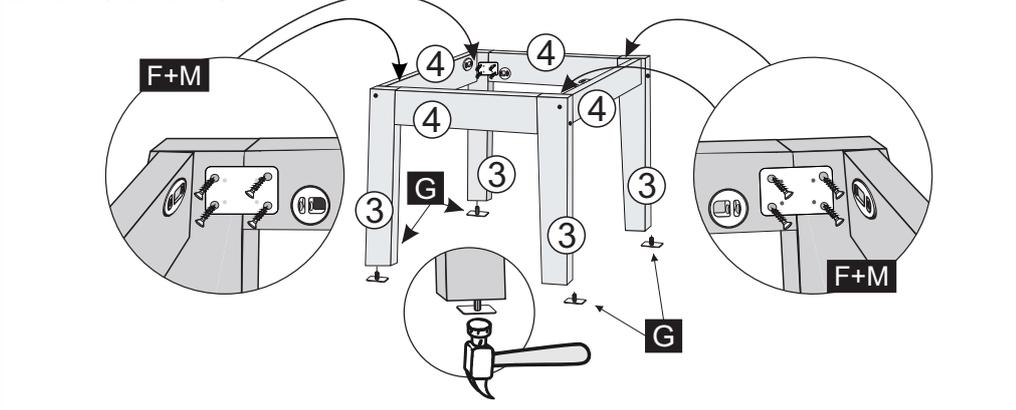
**6º - FINALIZAR A MONTAGEM PARAFUSANDO O ASSENTO NO CHASSI DE PÉS UTILIZANDO CANTONEIRAS 04 FUROS+PARAFUSOS 3,5X10.**
