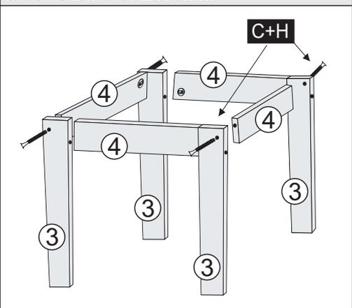
**5º - TRAVAR OS PÉS FRONTAL E TRASEIROS Nº3 COM AS TRAVAS LATERAIS Nº4 UTILIZANDO CHAPA JUNÇÃO 4 FUROS E PARAF. 3,5X14, EM SEGUIDA, FIXAR AS SAPATAS DESLIZADORAS NOS PÉS Nº3.**
