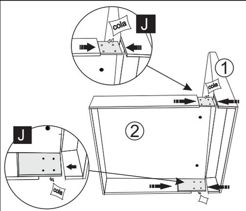
**2º - UNIR BEM O ASSENTO AO ENCOSTO, VERIFIQUE SE AS LATERAIS DO ASSENTO+ENCOSTO ESTÃO BEM JUNTAS, EM SEGUIDA, PARAFUSE O ASSENTO AO ENCOSTO UTILIZANDO PARAF. 07X40 CAB.17mm. LOGO APÓS, FIXAR AS CHAPAS(6mm) DO ASSENTO AO ENCOSTO, UTILIZANDO PARAF. 3,5X16.**
