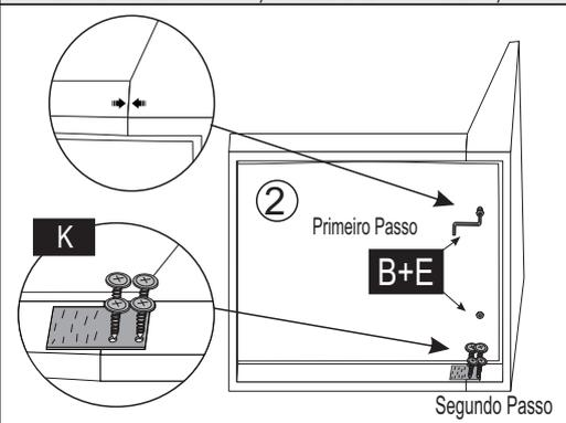
**3º - MONTAR OS PÉS Nº3 COM AS TRAVAS Nº4. FAZER LADO DIREITO E ESQUERDO. UTILIZANDO ANEL FIXADOR+PARAFUSOS 1/4X100 CAB 17mm.**
