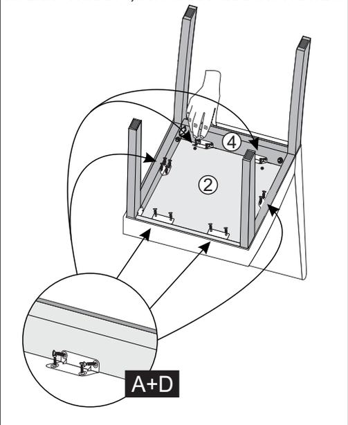
**7º - APÓS JUNTAR AS PEÇAS, CENTRALIZE O DETALHE UTILIZANDO AS MEDIDAS ABAIXO, EM SEGUIDA, POSICIONE O PARAFUSO ATRAVÉS DOS FUROS DO DETALHE Nº5 E PARAFUSE COM PARAF. 4,0X30 NO ENCOSTO Nº1, E FINALIZE COM TAMPA ADESIVO.**
