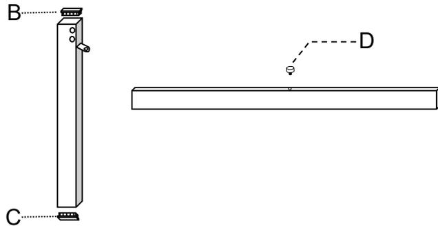
**2º PASSO:** COLOCAR TODAS AS TRAVESSAS E PARAFUSOS, DEIXANDO-AS SEM APERTO ATÉ A COLOCAÇÃO DO ULTIMO PARAFUSO.
