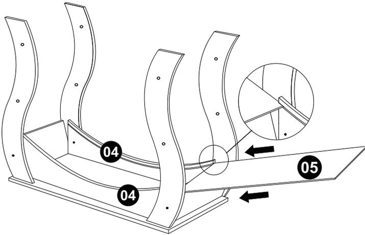
**04** Encaixar as peças estofadas 06 entre as peças 02 e fixá-las com parafusos (H) conforme desenho abaixo.
