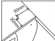
**06** Para aplicação do vidro 08 posicione os espaçadores (J) e cole as fitas dupla face (K) sobre o tampo de madeira 07 em seguida remova a película protetora e com ajuda de outra pessoa centralize o vidro 08 sobre o tampo, quando centralizado remova cuidadosamente os espaçadores (J) fazendo com que o vidro fixe sobre o tampo de madeira. Para finalizar fixe os tapa furos (I) sobre os parafusos (H) conforme o desenho abaixo.
