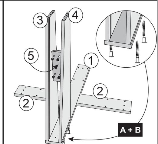
4º- Unir os módulos 2 ao módulo 1 utilizando parafusos 07x50 cab 10mm.
