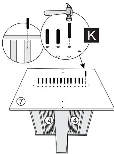
**9º - COLOQUE PARAF. 07X50 CAB. 10mm NOS FUROS DA PEÇA N.º7 E FIXE NAS PEÇAS N.º2.**
