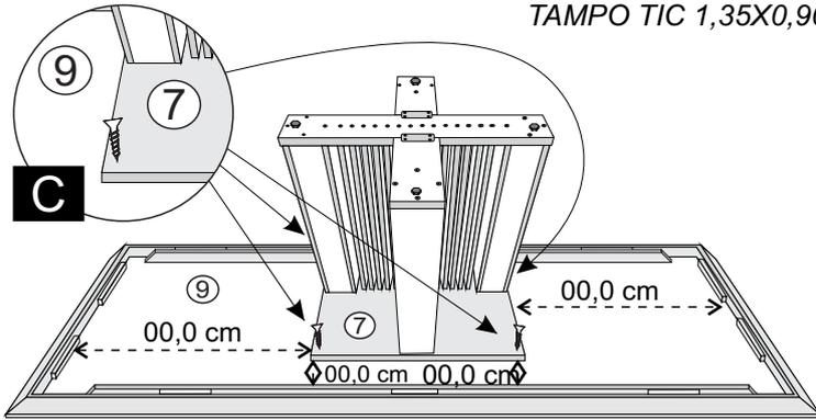
**14° - COLOQUE A BASE SOBRE O TAMPO N.º13, CENTRALIZE UTILIZANDO AS MEDIDAS ABAIXO, E FIXE UTILIZANDO PARAF. 4,0X25 FLANG. NA PEÇA N.º7;**
