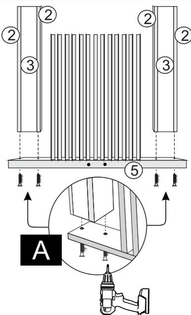
**6º - JUNTE AS PEÇAS N.º2 E N.º3 COM A PEÇA N.º6 E FIXE UTILIZANDO PARAF. 07X50 CAB.10mm. EM SEGUIDA, PASSE COLA NOS FUROS DA PEÇA N.º6 E COLOQUE CAVILHAS 12X50.**
