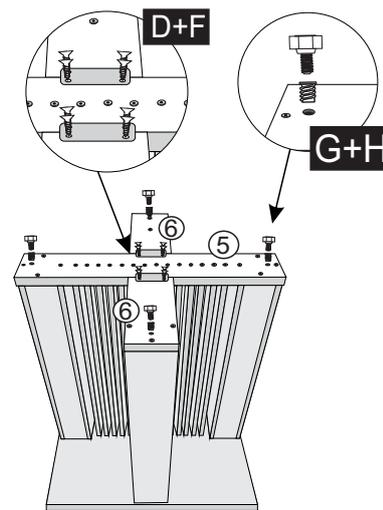
**11° - COLOQUE A BASE SOBRE O TAMPO N.º8, CENTRALIZE UTILIZANDO AS MEDIDAS ABAIXO, E FIXE UTILIZANDO PARAF. 4,0X25 FLANG. NA PEÇA N.º7;**
