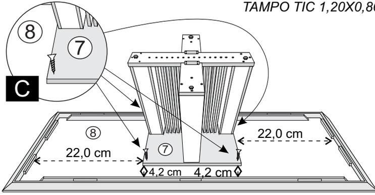
**14° - COLOQUE A BASE SOBRE O TAMPO N.º12, CENTRALIZE UTILIZANDO AS MEDIDAS ABAIXO, E FIXE UTILIZANDO PARAF. 4,0X25 FLANG. NA PEÇA N.º7;**
