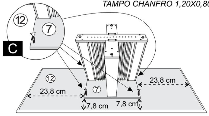
**11° - COLOQUE A BASE SOBRE O TAMPO N.º9, CENTRALIZE UTILIZANDO AS MEDIDAS ABAIXO, E FIXE UTILIZANDO PARAF. 4,0X25 FLANG. NA PEÇA N.º7;**
