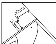
**06** Para aplicação do vidro 08 posicione os espaçadores (J) e cole as fitas dupla face (K) sobre o tampo de madeira 07 em seguida remova a película protetora e com ajuda de outra pessoa centralize o vidro 08 sobre o tampo, quando centralizado remova cuidadosamente os espaçadores (J) fazendo com que o vidro fixe sobre o tampo de madeira. Para finalizar fixe os tapa furos (I) sobre os parafusos (H) conforme o desenho abaixo.
