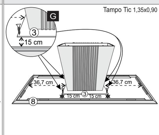
**7º** - CENTRALIZAR A PEÇA N.º3 COM AS MEDIDAS ABAIXO SOBRE O TAMPO N.º10 E FIXAR, UTILIZANDO PARAF. 4,0X25 FLANG.
