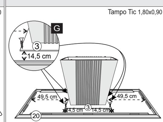
**13° - CENTRALIZAR A PEÇA N.º3 COM AS MEDIDAS ABAIXO SOBRE O TAMPO N.º22 E FIXAR, UTILIZANDO PARAF. 4,0X25 FLANG.**
