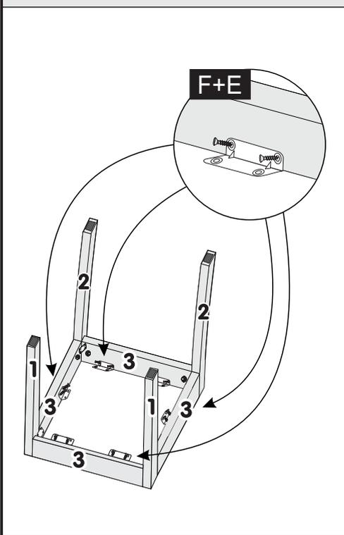
**4º - TRAVAR AS PEÇAS N.º1 E PEÇA N.º2 COM AS PEÇAS N.º3, UTILIZANDO CHAPA JUNÇÃO 04 FUROS E PARAF. 3,5X14. EM SEGUIDA, FIXAR AS SAPATAS DESLIZADORA NAS PEÇAS N.º1 E N.º2.**
