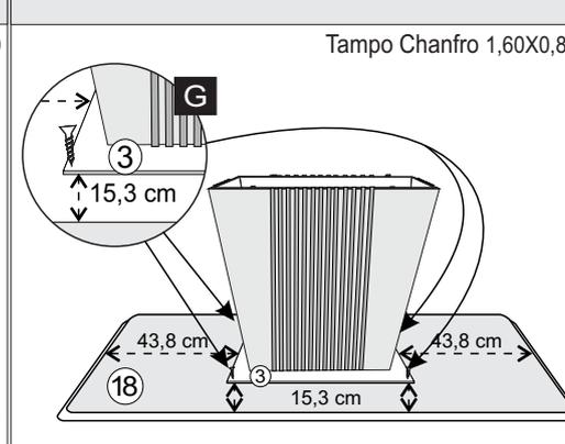
**12º** - CENTRALIZAR A PEÇA N.º3 COM AS MEDIDAS ABAIXO SOBRE O TAMPO N.º20 E FIXAR, UTILIZANDO PARAF. 4,0X25 FLANG.
