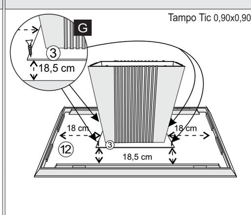
**9º** - CENTRALIZAR A PEÇA N.º3 COM AS MEDIDAS ABAIXO SOBRE O TAMPO N.º14 E FIXAR, UTILIZANDO PARAF. 4,0X25 FLANG.
