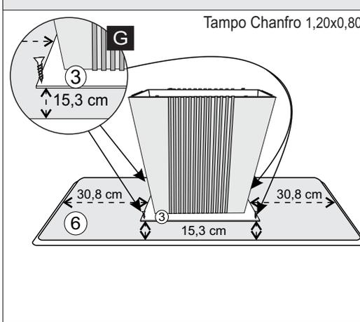
**6º** - CENTRALIZAR A PEÇA N.º3 COM AS MEDIDAS ABAIXO SOBRE O TAMPO N.º8 E FIXAR, UTILIZANDO PARAF. 4,0X25 FLANG.
