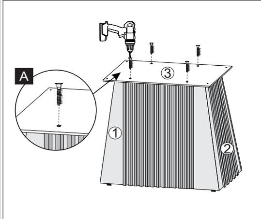
**4º** - CENTRALIZAR A PEÇA N.º3 COM AS MEDIDAS ABAIXO SOBRE O TAMPO N.º4 E FIXAR, UTILIZANDO PARAF. 4,0X25 FLANG.
