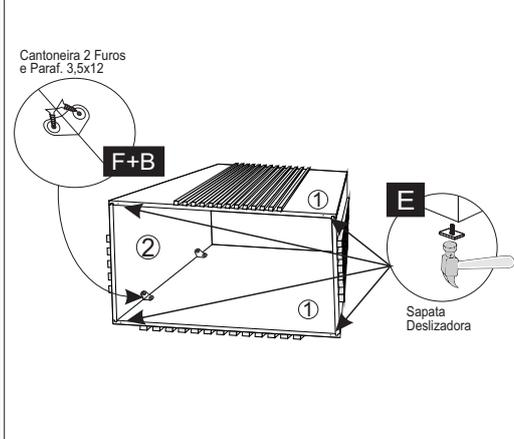
**3º** - COLOQUE A PEÇA N.º3 SOBRE AS PEÇAS N.º1 E N.º2 E PARAFUSE PELOS FUROS COM PARAF. 07X40 CAB. 10mm.
