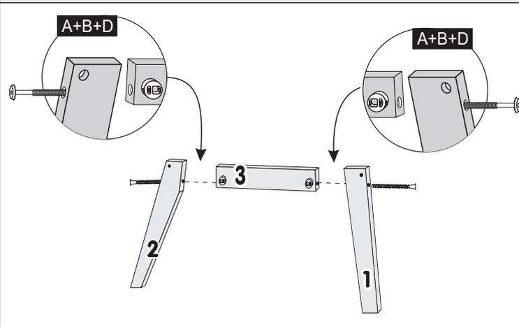
**2º - UNIR O CONJUNTO LATERAL COM AS PEÇAS N.º3, UTILIZANDO ANEL FIXADOR+PARAF. 1/4X70 CAB. 13mm. COM CHAVE ALLEN 4mm.**
