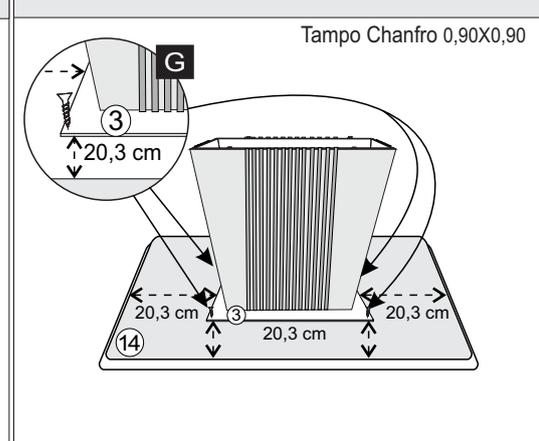
**10º** - CENTRALIZAR A PEÇA N.º3 COM AS MEDIDAS ABAIXO SOBRE O TAMPO N.º16 E FIXAR, UTILIZANDO PARAF. 4,0X25 FLANG.
