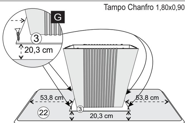
**14° - PARA FINALIZAR A MONTAGEM, RETIRE A FITA DUPLA FACE DA CARTELA E COLE SOBRE O TAMPO. EM SEGUIDA, RETIRE A PELÍCULA DA FITA E POSICIONE O VIDRO DIVIDINDO AS RAZÕES SOBRE O TAMPO.**
