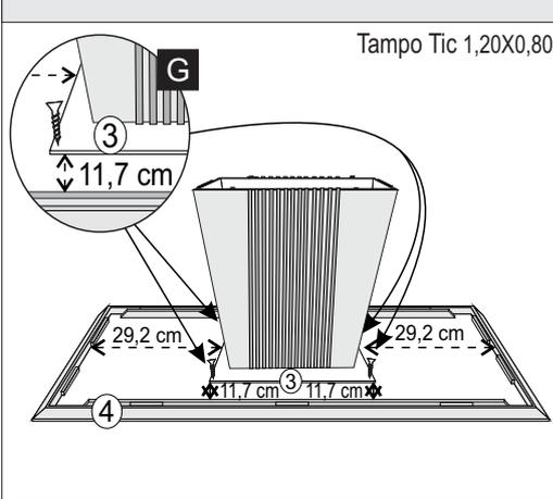
**5º** - CENTRALIZAR A PEÇA N.º3 COM AS MEDIDAS ABAIXO SOBRE O TAMPO N.º6 E FIXAR, UTILIZANDO PARAF. 4,0X25 FLANG.
