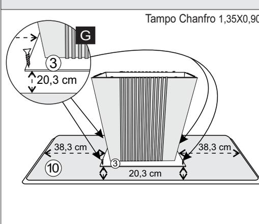
**8º** - CENTRALIZAR A PEÇA N.º3 COM AS MEDIDAS ABAIXO SOBRE O TAMPO N.º12 E FIXAR, UTILIZANDO PARAF. 4,0X25 FLANG.
