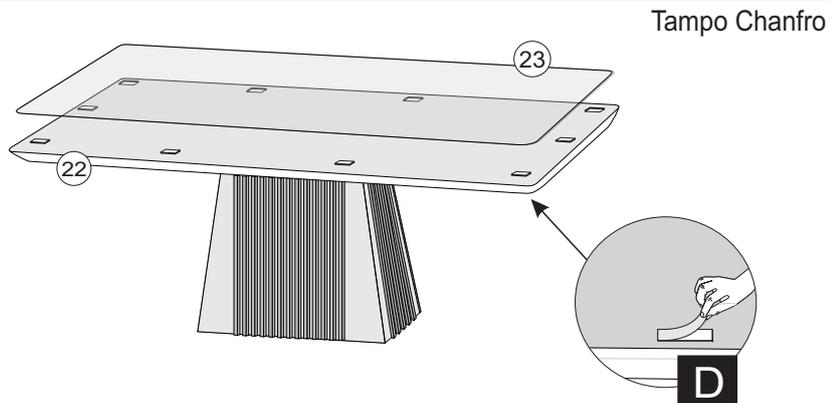
**15° - PARA FINALIZAR A MONTAGEM, RETIRE A FITA DUPLA FACE DA CARTELA E COLE SOBRE O TAMPO. EM SEGUIDA, RETIRE A PELÍCULA DA FITA E POSICIONE O VIDRO DIVIDINDO AS RAZÕES SOBRE O TAMPO.**
