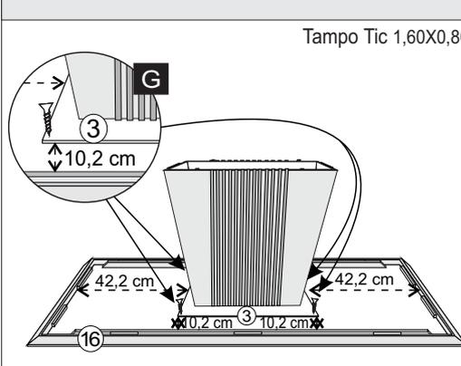
**11º** - CENTRALIZAR A PEÇA N.º3 COM AS MEDIDAS ABAIXO SOBRE O TAMPO N.º18 E FIXAR, UTILIZANDO PARAF. 4,0X25 FLANG.
