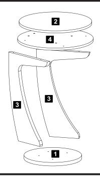
Descrição Descripción Description 1-Base (380x380x25mm) 1-Base 1-Base 2-Tampo (480x480x15mm) 2-Tapa 2-Top 3-Lateral (590x360x25mm) 3-Side 3-Lateral
