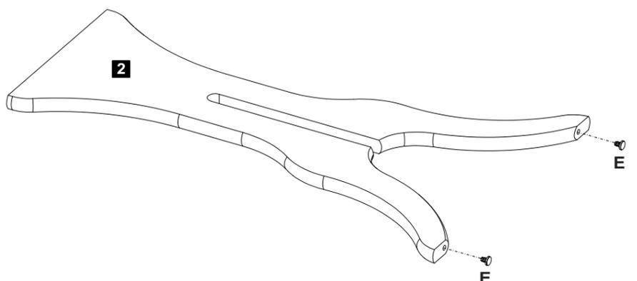
**E** Sapata Fixa Ø5x10mm **02**
