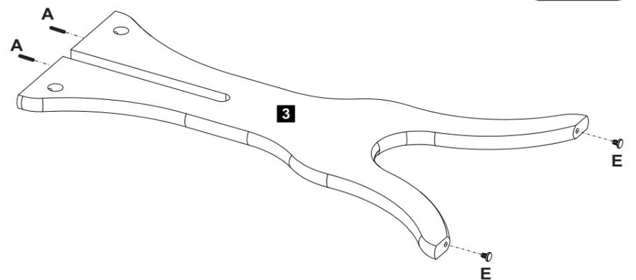
**A** Cavilha **02** **E** Sapata Fixa Ø5x10mm **02**
