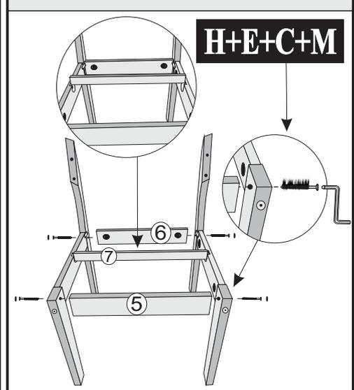
3º - UNIR ENCOSTO Nº8 COM PÉ Nº2 E Nº4 COM PARAF. 07X50 CAB. 13mm+CHAVE ALEN ZETA NA FURAÇÃO (B). EM SEGUIDA USAR PARAF. 07X70 CAB.13mm NA FURAÇÃO (K) + CHAVE ALEN. EM SEGUIDA COLOCAR TAMPA FURO 13mm.
