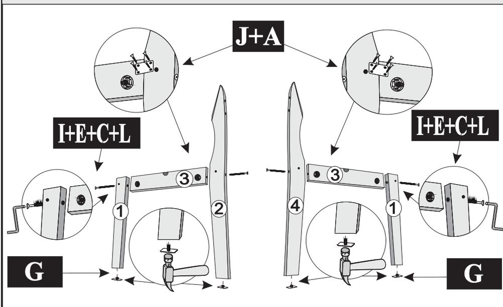
2º - UNIR O CONJUNTO LATERAL COM A TRAVA Nº5 E TRAVA Nº6 UTILIZANDO ANEL FIXADOR + PARAFUSOS 1/4X70 CAB.13mm, FINALIZAR COM TAMPA FURO 13mm. POSICIONAR TRAVA CENTRAL Nº7.
