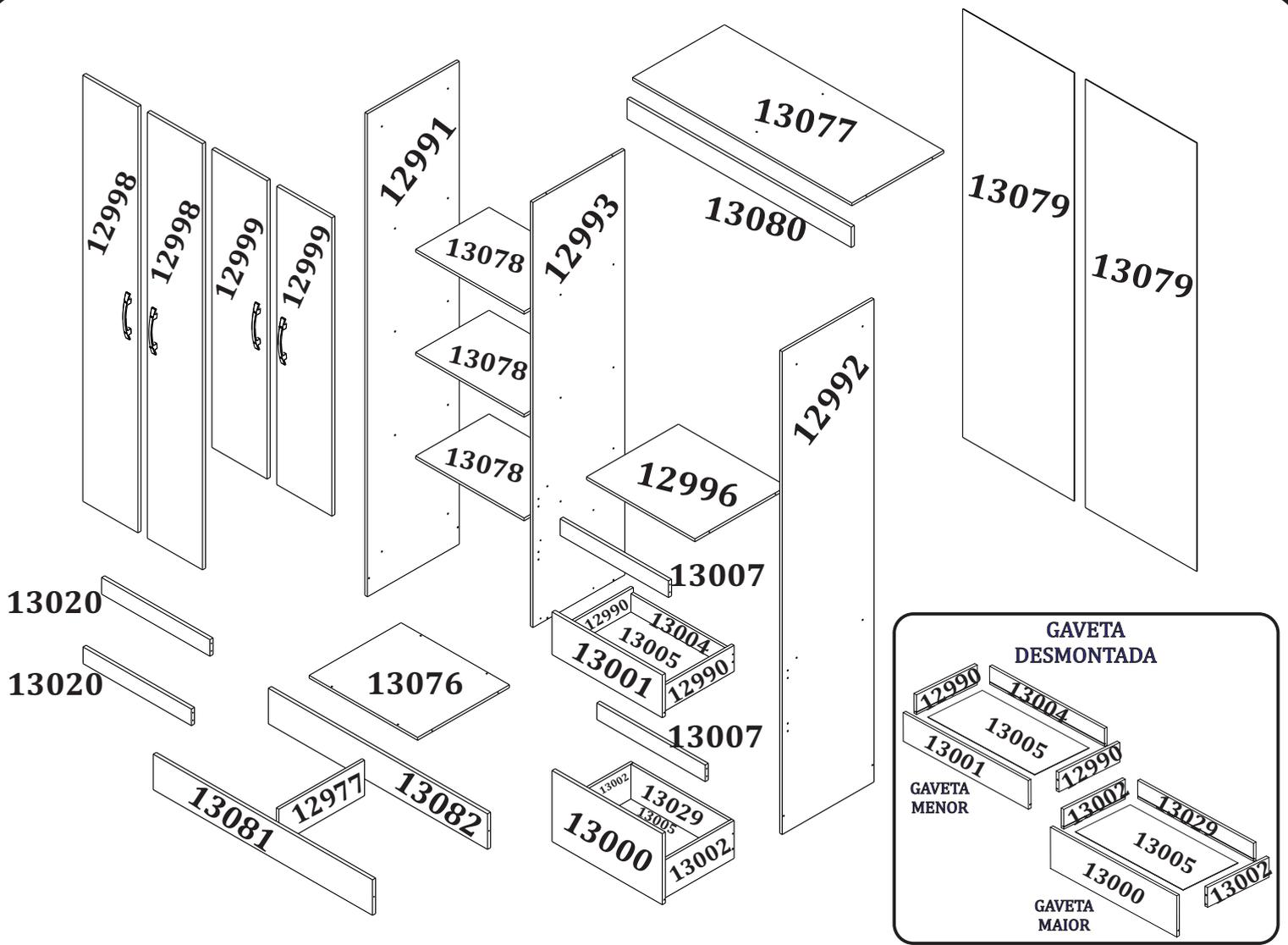
**1** Fixe a base (13076) com o parafuso (2505) e a travessa (12977) utilizando a cantoneira (2466) com o parafuso (2503) nos rodapés (13081/13082). Em seguida, fixe a sapata (11063) nos rodapés e nas laterais (12991/12992) com o parafuso (2503).
