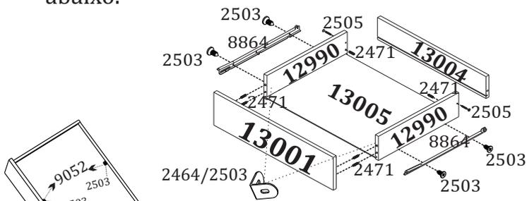
**Obs: Coloque o suporte triangular (9052) no fundo de gaveta, para aumentar sua sustentabilidade utilizando o parafuso (2503).**
