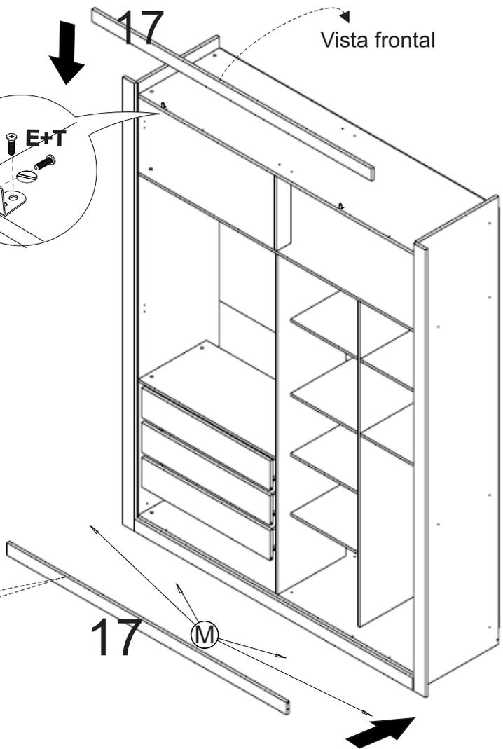
**FIXAR VISTA NO RODAPÉ DE DENTRO PARA FORA COM PARAFUSOS 3,5X25MM ( J ), DEIXANDO 5 MM SOBRANDO PARA CADA LADO.**
