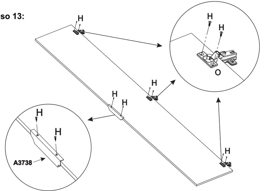
Montar as dobradiças nas portas, e após fixar as mesmas nas marcações superiores e inferiores das laterais e da divisória.
