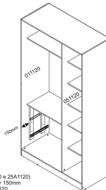
Fixar os calços de correção (251120 e 25A1120) com parafusos 3,5x35mm P e deixar 150mm de distância das peças 011120, 051120.
