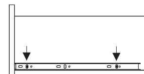
Fixação da parte móvel dos trilhos telescópico (A3331) nas gavetas com parafuso H.
