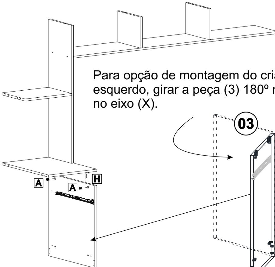
Para opção de montagem do criado no lado esquerdo, girar a peça (3) 180° na horizontal no eixo (X).
