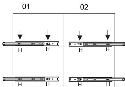
Fixar as correções nas laterais com parafusos H.
