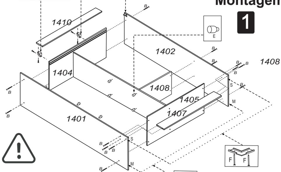
Para fixar a peça 1410 usar a cantoneira C e o parafuso S é fixado atrás da peça 1404 precisamos deixar alinhado com as laterais. Fixar o rodapé, peça 1407 no final da montagem
