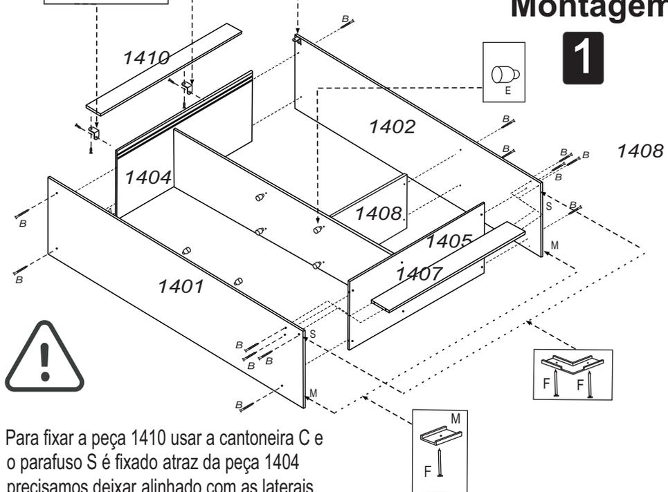
Para fixar a peça 1410 usar a cantoneira C e o parafuso S é fixado atrás da peça 1404 precisamos deixar alinhado com as laterais. Fixar o rodapé, peça 1407 no final da montagem
