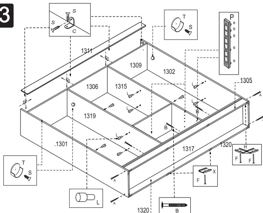
\* Para fixar a peça 1311 usar a cantoneira C e o parafuso S é fixado na peça 1306, precisando deixar alinhado com as laterais.
