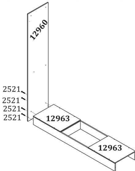
**3** Fixe a lateral (12959) nos rodapés e na base (12963), utilizando o parafuso (2521).
