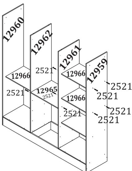
**7** Fixe as cavilhas (2473) no topo das divisões e em seguida, encaixe o tampo (12964) sobre elas, fixando com o parafuso (2521) nas laterais.
