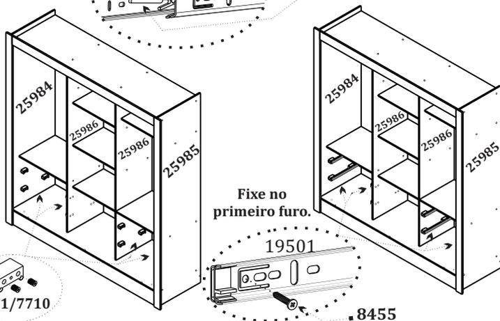
**11** Encaixe as gavetas. Fixe o trilho sup. (14764) e o trilho inf. (8970) utilizando os parafusos (2503). Fixe os suportes de cabideiro (2576) utilizando os parafusos (2503).
