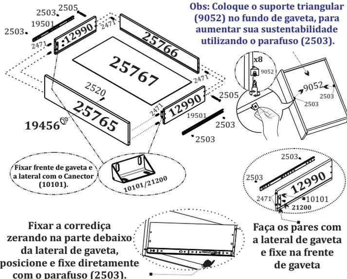
Fixar a correção zerando na parte de baixo da lateral de gaveta, e fixe diretamente com o parafuso (2503).
