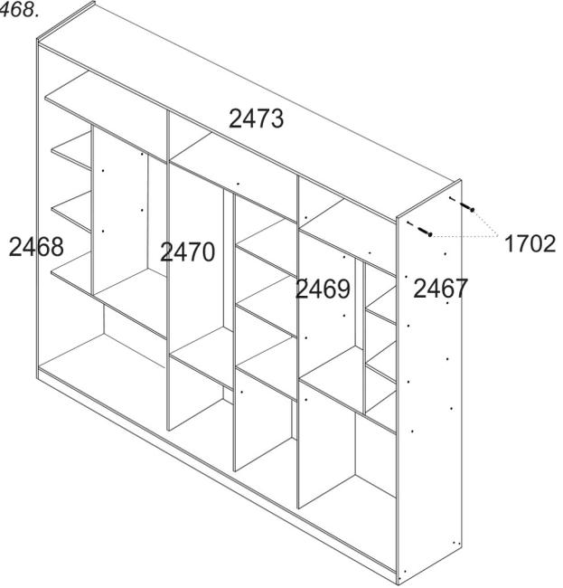
**8** Fixar moldura superior 2480 ao tampo 2473, em seguida fixe moldura lateral 2481 nas laterais 2467/2468, utilizando cantoneira 2514 e parafusos 2365.
