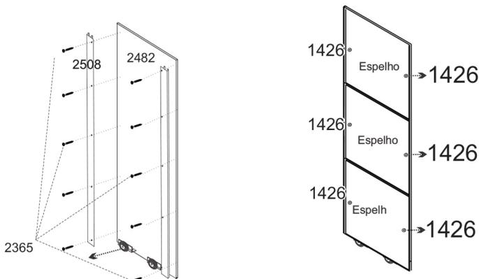
**13** Encaixe as portas no roupeiro. Primeiro encaixe a parte superior no trilho 2504, em seguida encaixe a parte inferior, roldana 1768 sobre trilho 2509.
