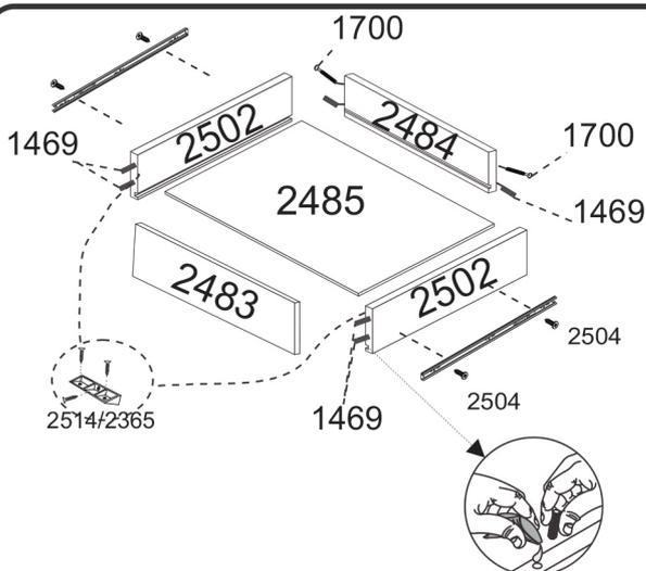
Fixar a frente da gaveta 2483 na lateral 2502, utilizando a cantoneira 2514 e parafuso 2365, usar cola 2697 nas cavilhas 1469.
