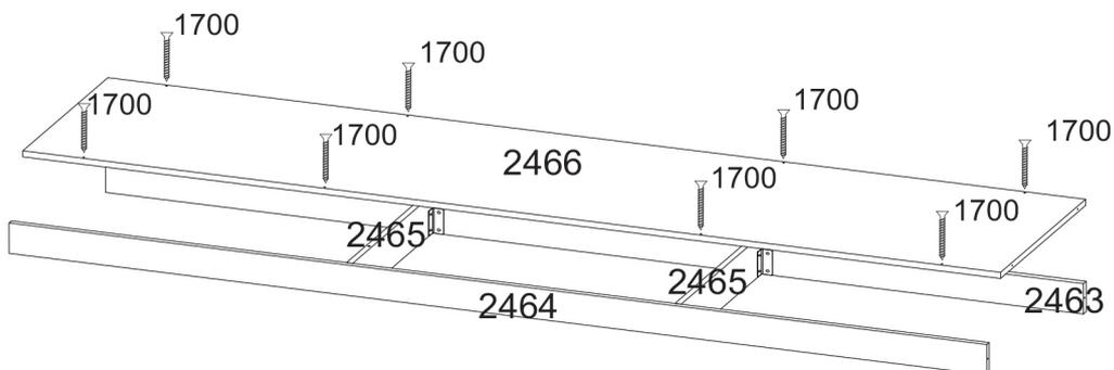
**3** Fixar sapatas 1472 nas laterais 2467/2468 em seguida fixar lateral 2467 nos rodapés 2463/2464 e base 2466 utilizando parafusos 1702. Encaixar divisão interna 2469 sobre base 2466 utilizando cavilha 1470, em seguida fixe prateleira 2476 na lateral 2467 e divisão 2469 utilizando parafusos 1702.
