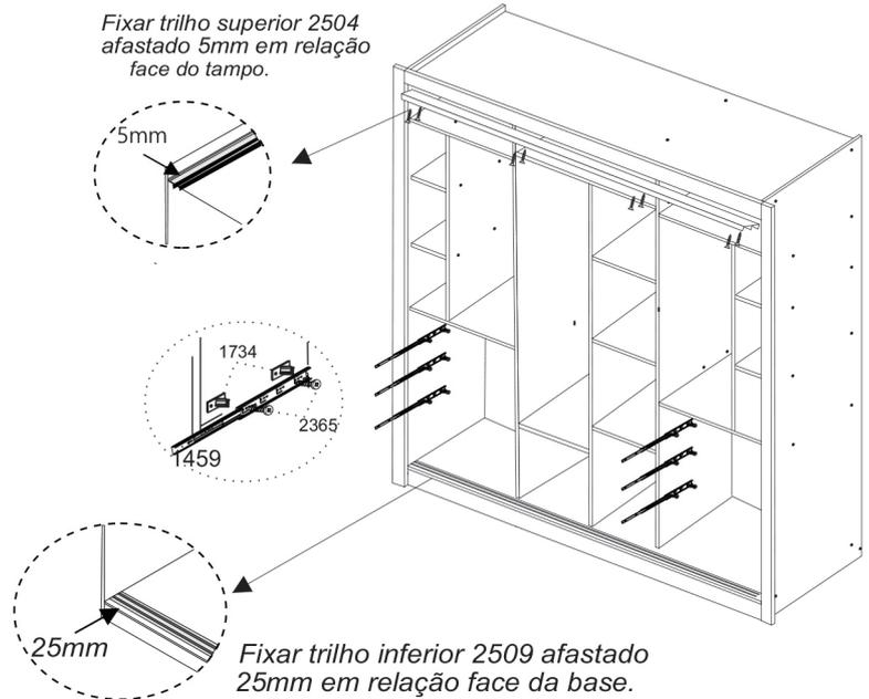
**11** Montar as gavetas de acordo com a orientação abaixo, em seguida encaixe nas corredeiras instaladas no roupeiro.
