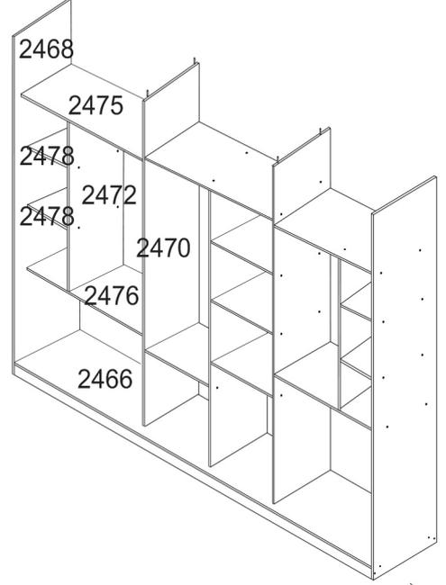
**7** Encaixe tampo 2473 sobre divisões 2469/2470 com cavilha 1470, em seguida com parafuso 1702 fixe o tampo nas laterais 2467 2468.
