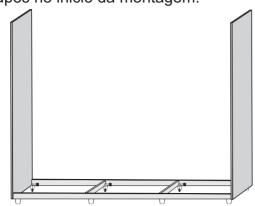
o1 Inicie a montagem utilizando parafuso "A" para fixar os rodapés nº01, 02 e 03. Fixe a base nº06 utilizando parafuso "D" e fixe as sapatas "J" com parafuso "C".
