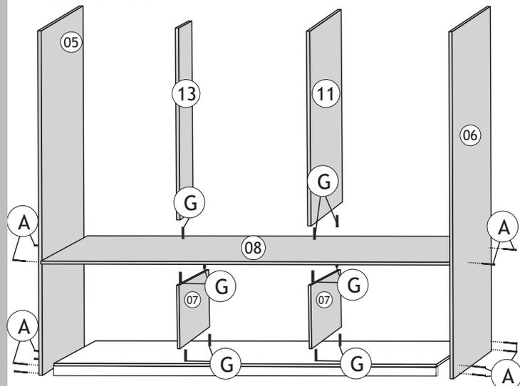
**03** Fixe as prateleiras nº12 com parafuso "A". Fixe a divisão nº13 e nº11 no tampo nº09 com cavilha "G". Fixe os tampos nº09 com parafuso "A". Coloque o suporte "M".
