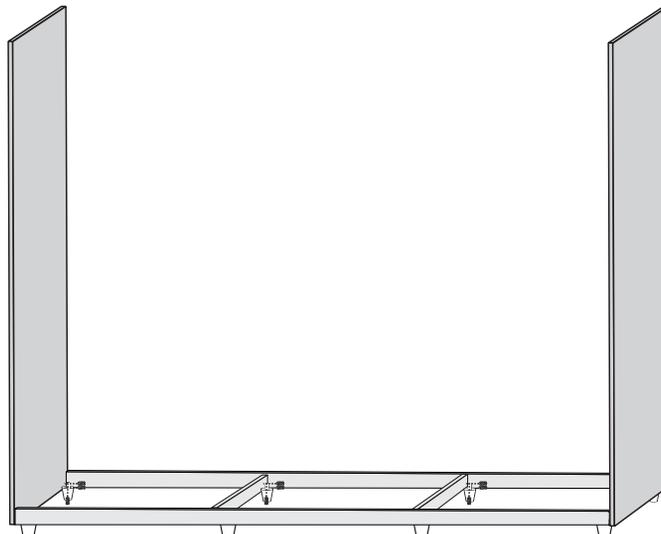
**01** Inicie a montagem fixando os rodapés nº01, 02 e 03 com parafuso "A". Fixe a base no rodapé com parafuso "D" alinhando as extremidades. Coloque as sapatas "J".
