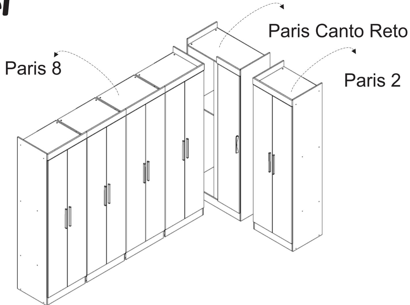
Para a montagem da modulação primeiro monte cada Roupeiro separado, como nas instruções a seguir e depois faça a montagem final , juntando os três módulos
