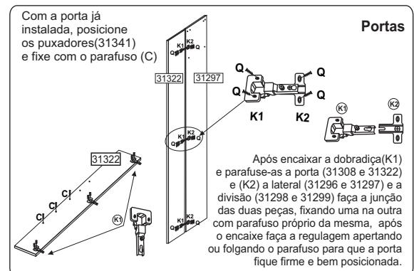
Após encaixar a dobradiça(K1) e parafuse-as a porta (31308 e 31322) e (K2) a lateral (31296 e 31297) e a divisão (31298 e 31299) faça a junção das duas peças, fixando uma na outra com parafuso próprio da mesma, após o encaixe faça a regulagem apertando ou folgando o parafuso para que a porta fique firme e bem posicionada.
