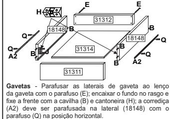
Gavetas - Parafuse as laterais de gaveta ao lenço da gaveta com o parafuso (E); encaixar o fundo no rasgo e fixe a frente com a cavilha (B) e cantoneira (H); a corredera (A2) deve ser parafusada na lateral (18148) com o parafuso (Q) na posição horizontal.
