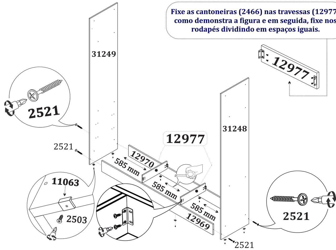
**2** Fixe a base (31252) nas laterais utilizando os parafusos (2521) e em seguida fixe sobre os rodapés com os parafusos (2505).
