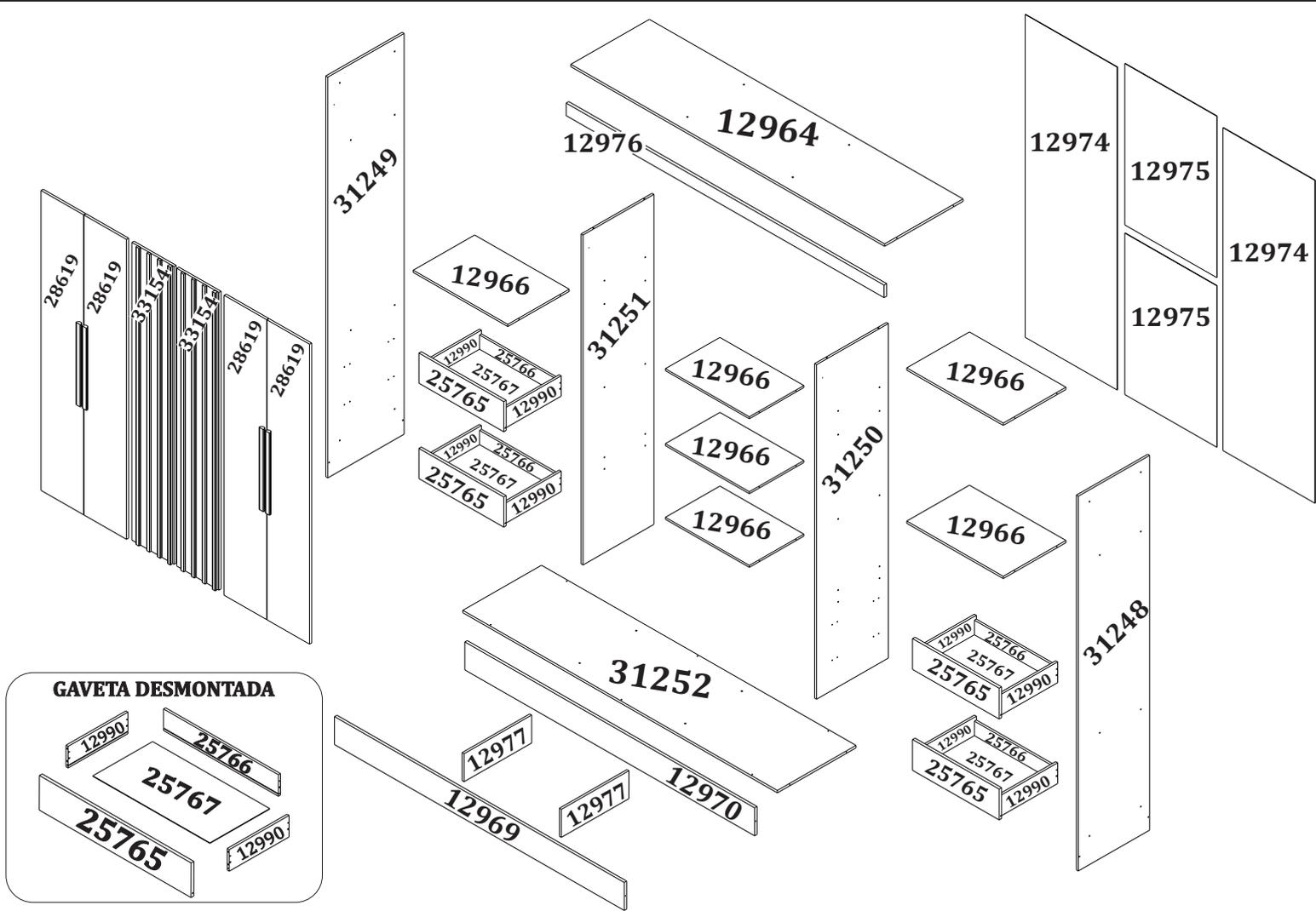
**1** Fixe as sapatas (11063) nas laterais (31248/31249) e nos rodapés (12969/12970) com os parafusos (2503). Fixe as travessas (12977) entre os rodapés utilizando as cantoneiras (2466) e os parafusos (2503). Em seguida, fixe as laterais no rodapé com os parafusos (2521).
