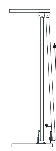
Montando a porta central nos trilhos.
