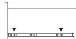
Fixação da parte móvel dos trilhos telescópico (A1762) nas gavetas com parafuso H.
