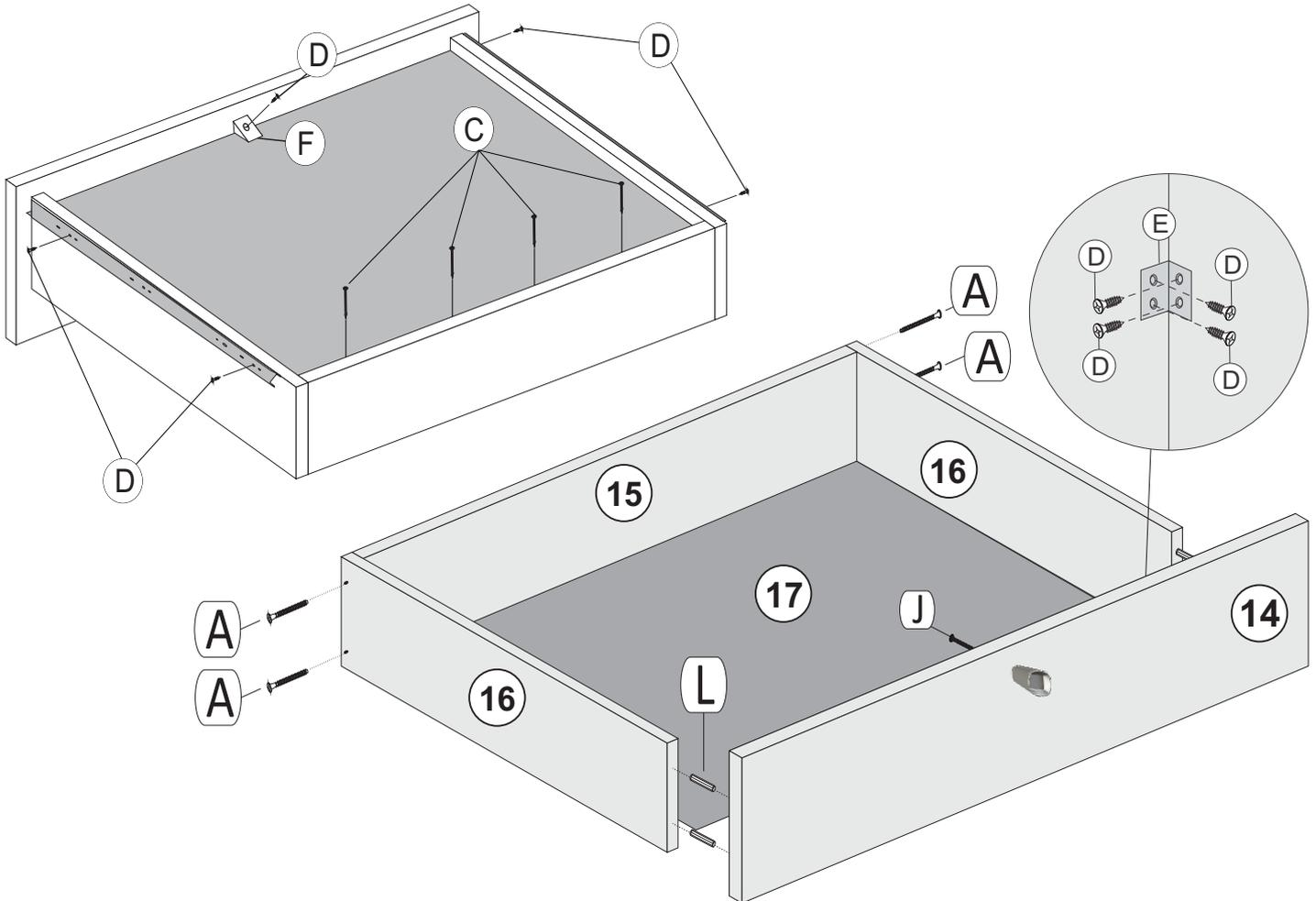
\*\*\* Se a corredeira estiver pesada de forma anormal, verifique se está encaixada corretamente nas canaletas, retire-a e torne a encaixar verificando novamente.
