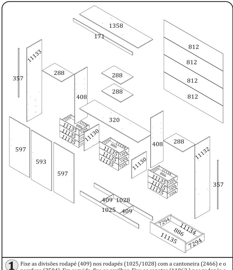
Fixe as divisões rodapé (409) nos rodapés (1025/1028) com a cantoneira (2466) e o parafuso (2504). Em seguida, fixe as cavilhas. Fixe as sapatas (11063) nos rodapés e nas laterais utilizando o parafuso (2504).
