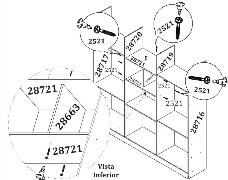
**6** Encaixe o tampo (23478) sobre as cavilhas fixadas nas divisões e em seguida, fixe nas laterais utilizando os parafusos (2521). Fixe os afastadores (9484/9485) nas laterais e nas divisões com os parafusos (2523).
