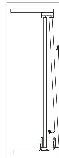
Montando a porta central nos trilhos.
