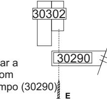
**Moldura** - Parafusar a moldura (30302) com parafuso (30290) ao tampo (30290).
