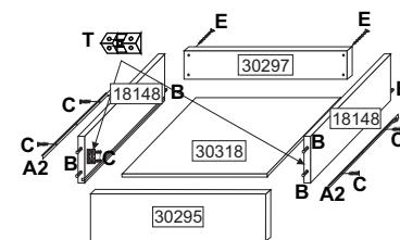
**Gavetas** - Parafusar as laterais de gaveta ao lenço da gaveta com o parafuso (E); encaixar o fundo no rasgo e fixe a frente com a cavilha (B) e cantoneira (T); a corrediça (A2) deve ser parafusada na lateral (18148) com o parafuso (C) na posição horizontal.
