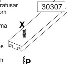
Encaixar as Molas (X) no trilho (30307) e parafusar de baixo para cima com o parafuso (P) no tampo (30290) de forma que o trilho fique flexível. A regulagem das portas são através do parafuso, folgue o parafuso ou aperte um pouco se necessário.
