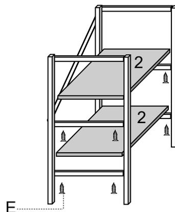
**4º PASSO:** PARAFUSAR O TAMPO NA ARMAÇÃO JÁ MONTADA CONFORME O DESENHO E COLOCAR AS TAMPINHAS DE ACABAMENTO.
