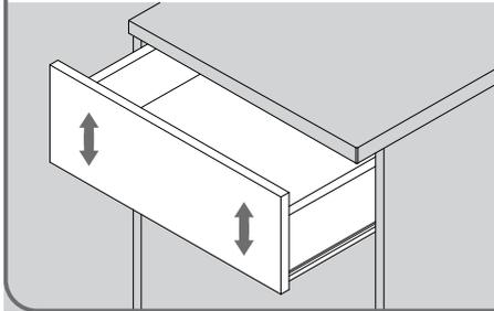
**Ajustar a gaveta e colocar os parafusos**
