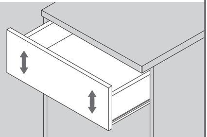
Ajustar a gaveta e colocar os parafusos
